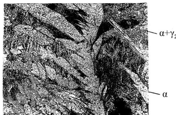
Рисунок 1. Микроструктура диффузионного слоя (образец № 1), x500
